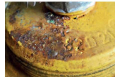
**Korrosionsschaden an Flasche und Ventil durch Ammoniaklösung**
