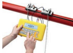
**Durchflussmessgerät I** Art. Nr. 7394
